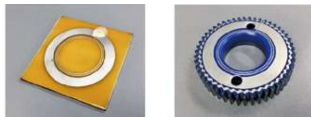
図5 観測用アンテナとスマートギヤ [出典:文献3)]
