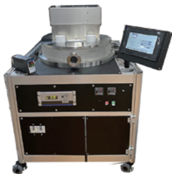
本技術の処理装置。同一チャンバー内で全ての工程を行うことができる。
