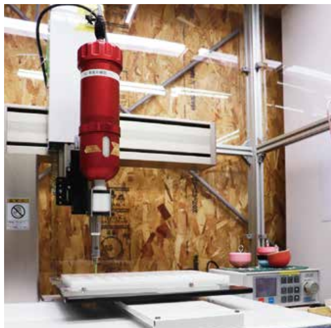
シリコン成型工程に導入した自動吐出機
