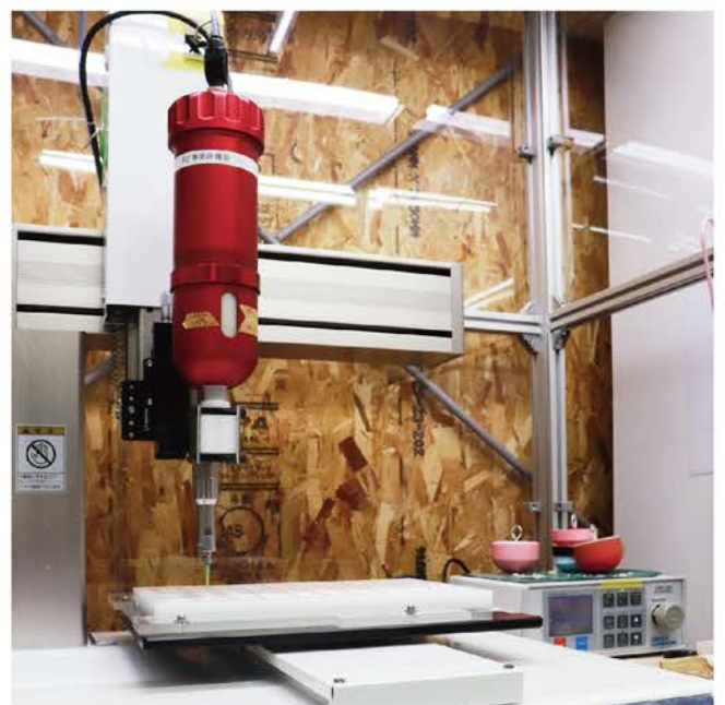
シリコン成型工程に導入した自動吐機
