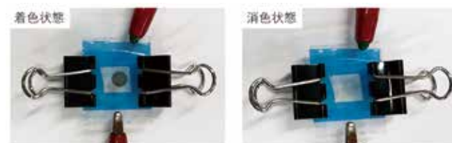
図6 作製したエレクトロクロミック素子の色調変化の様子
