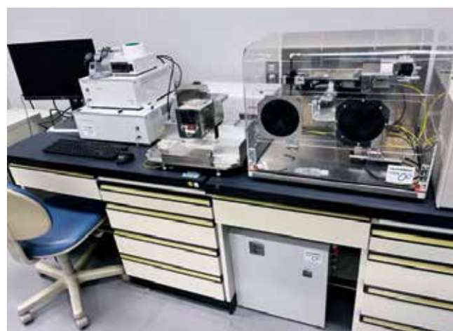
写真 当センターのテラヘルツ非破壊検査装置 (アドバンテスト製TAS7500TS)
