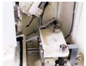
シリンダーと先端ツールで人の手の動きを再現
