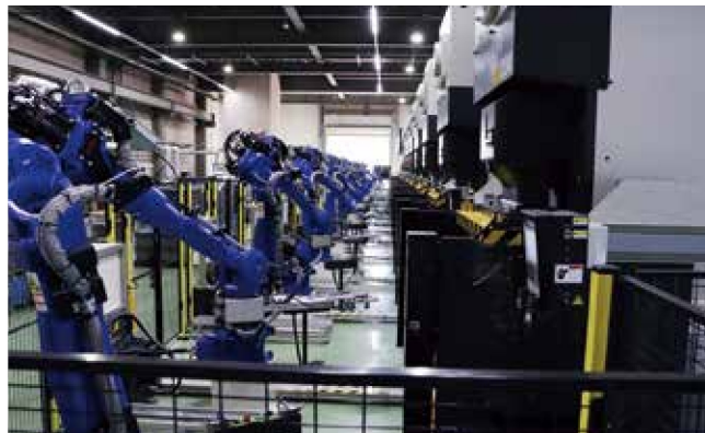
「ダイレクトシールド構造ヒートインシュレーター」の全自動生産ライン
