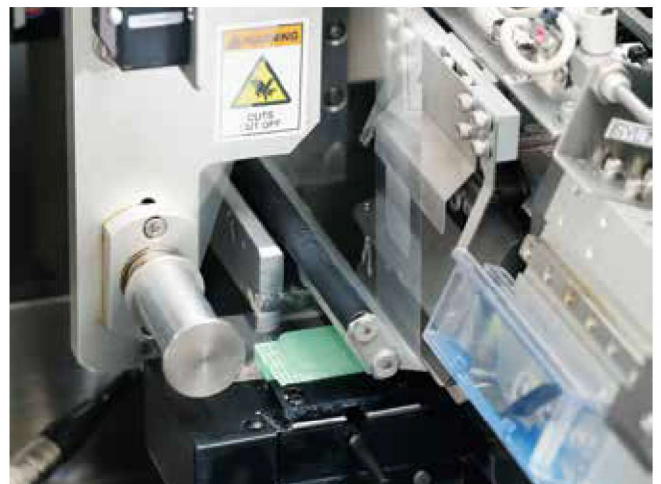
数ミクロンで薄切された切片を、静電気を利用して樹脂テープに貼り付ける
