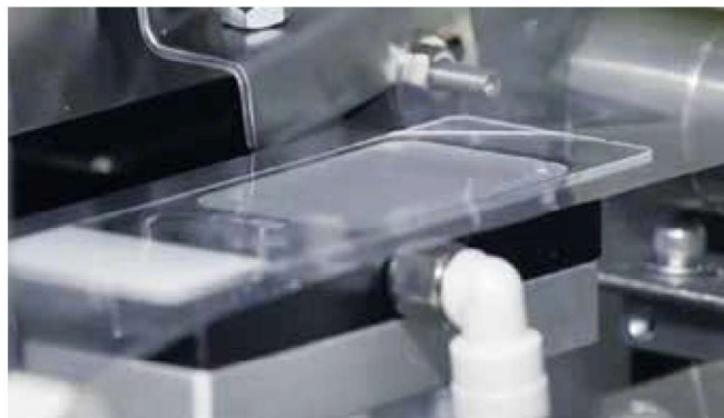
水の表面張力を利用し、薄切された切片をテープからスライドガラスへ転写
