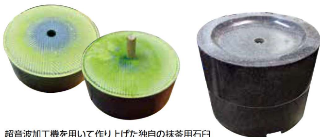
超音波加工機を用いて作り上げた独自の抹茶用石臼
