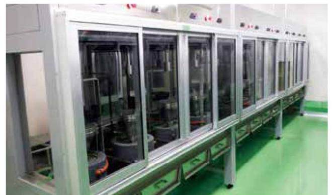
抹茶製造マシン「伸栄式ステンレス石臼機オーガニックタイプ」
