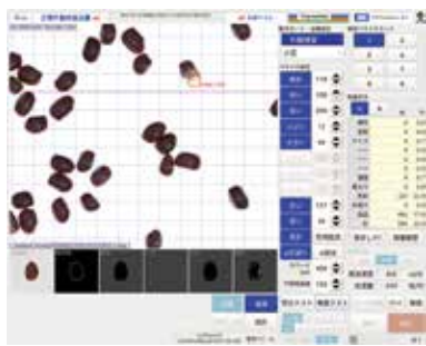
「DrBean AI手選りさん」の学習画面。表面変化も区別できる。
