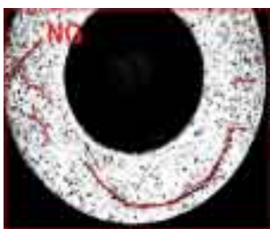
【 外観検査（キズ・汚れ） 】
