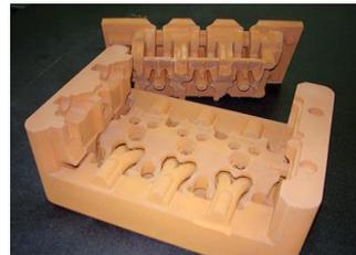
新材料により、造形速度・造形品強度・造形品精度が大幅にアップした铸造用砂型
