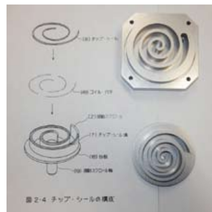
左側が既存の旋回スクロールチップシールの構成
