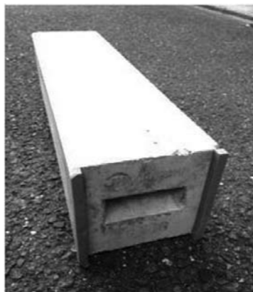
境界ブロックの断面に目地枠を張り付けた様子
