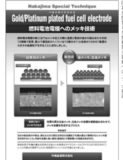
同社が開発した燃料電池電極へのメッキ技術
