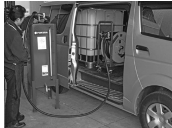
ワゴン車を改造したIBC運搬専用車
