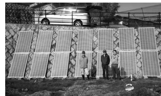
製作された軽量でフレキシブルな太陽電池
