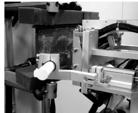
使用顔料などの推測に役立つ蛍光X線分析装置
