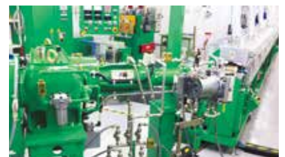
LEDフレキシブルライトの押出成形装置
