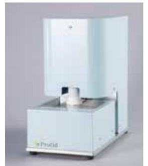
接触冷感試験機「THERMOFEEL」
