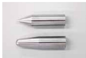
図2 放電電極 上: 接触放電用 下: 気中放電用
