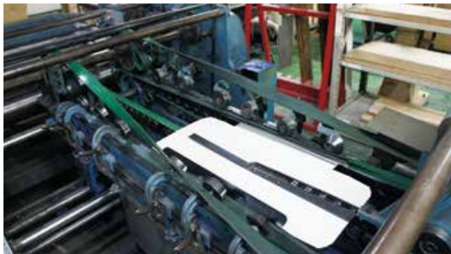
側面を折る工程
