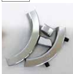
金属試料とそれぞれ溶解した試料
