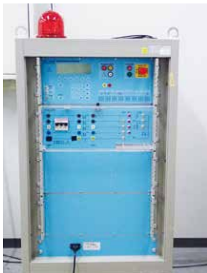
図1 雷サージ試験機
