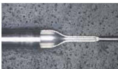
Co-Ni-Cr-Mo合金の外径φ1.5mm、 内径φ0.2mmまで鏡面研磨
