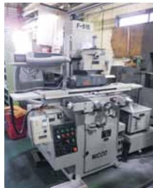
刷新された成型平面研削盤
