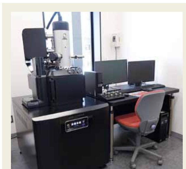
走査電子顕微鏡(JSM-IT-300HR/LA)(観察+結晶方位分析)
