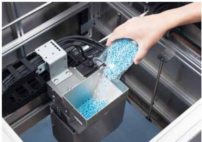
ペレット状の材料を投入し、成形できる
