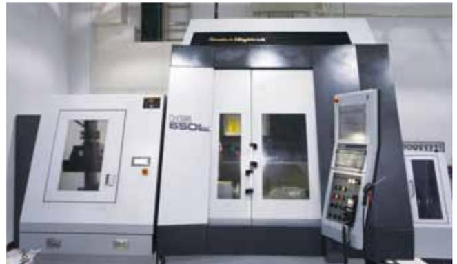
超高精度加工を実現するリニア駆動5軸加工機
