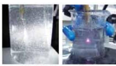
図2 マイクロバブル発生と放電の様子
