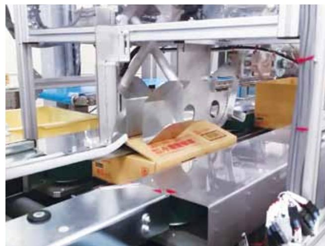
ロボットを用いた外装包装装置
