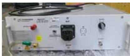
雑音端子電圧測定機器
