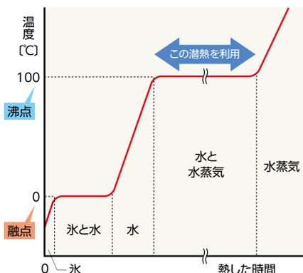
加熱を続けても気化する温度は変わりませんが、さらに一定熱量を加えると、高い熱量を持った水蒸気になります。当社のヘアスチーマーは、この原理を使ったもので、圧力釜で2気圧に加圧すると、水の沸点は120℃まで上昇し、高い熱量を持った水蒸気が勢いよく噴射します。高圧力と高温下で発生させた水蒸気が髪の毛に当たって水になり、潜熱を放出して熱を発します。
