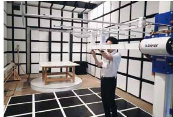
電波暗室でのEMC試験の様子
