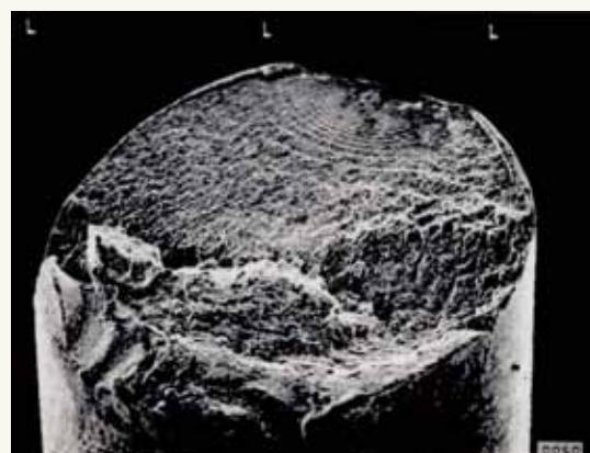
図2 軸破面の顕微鏡観察像
