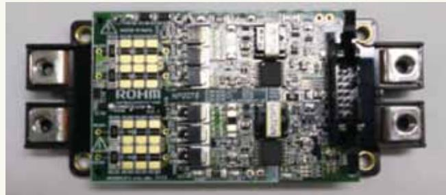
図4 SiCパワーモジュール(ROHM製, 1200V, 300A)
