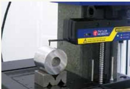
図2 触針式表面粗さ測定の例
