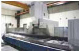
最長6mの長尺部品を加工するマシニングセンタ
