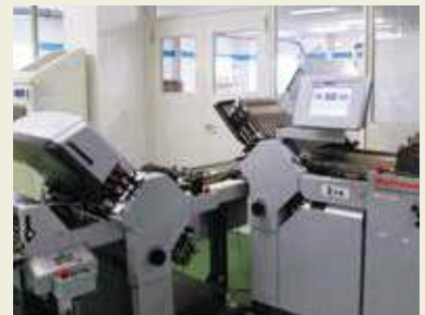
幅20mmの極小折製本印刷物の加工に対応する折機
