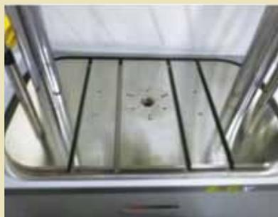
恒温槽を付属し、-30℃から200℃の温度環境下での試験が行えます。
