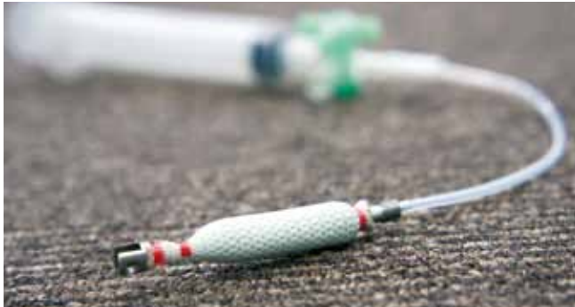
組紐編みの技術を生かして編んだ空気圧アクチュエータ
