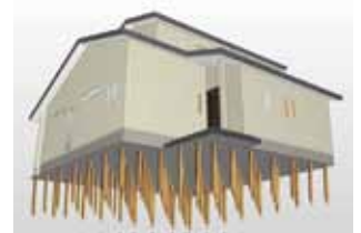
木杭による地盤補強
