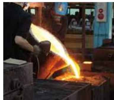
溶けた鉄を型に流し込む鑄込み作業
