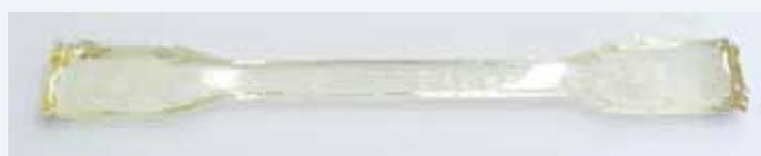
図1 ラピッドプロトタイピング簡易型を用いた引張強度試験片成型品写真
