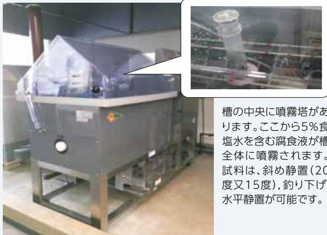
槽の中央に噴霧塔があります。ここから5%食塩水を含む腐食液が槽全体に噴霧されます。試料は、斜め静置(20度又は15度)、釣り下げ、水平静置が可能です。
