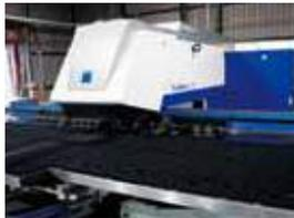
最新鋭トルンプ製のレーザー加工複合機
