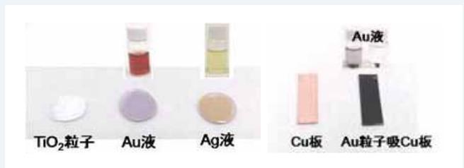
図3 粒子が吸着した素材の状態
