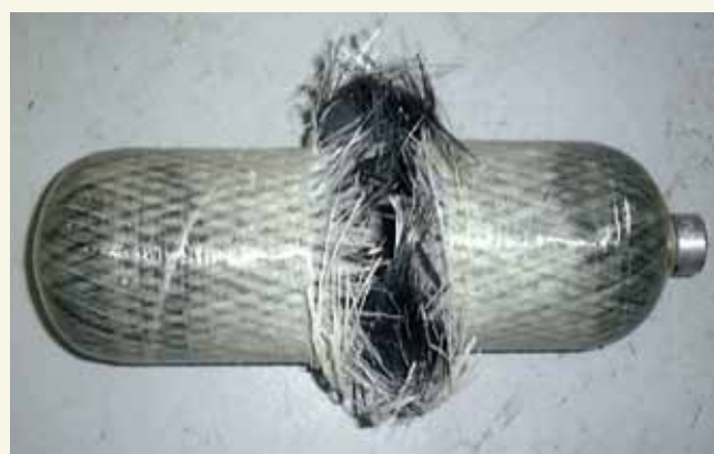
圧力容器の破損の様子
