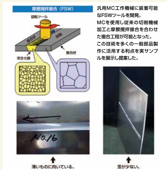
摩擦攪拌接合の模式図と接合サンプル
