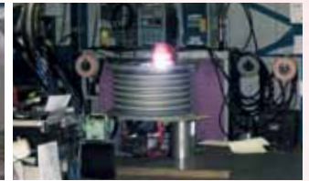
手作業でベローズに溶接を行う製造スタッフ(中央)
