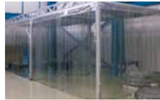
「大口径・極薄肉・超高真空ベローズ」の加工を行うハイレベルなクリーンブース
