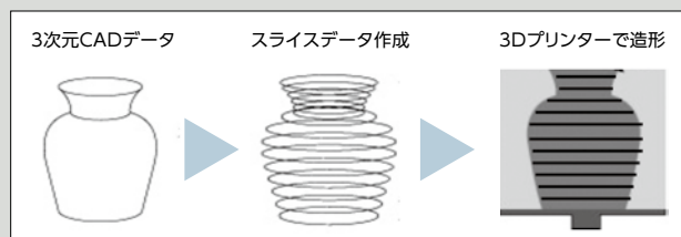
図1 3Dプリンターによる造形手順
