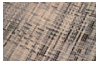
▲幅4mmのテープを織り込むリボン織り
