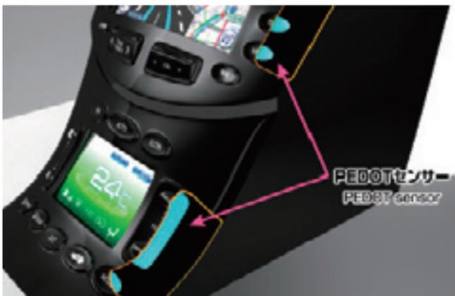
上記ヒーターコントロールパネルに加え、ナビゲーションのスイッチ部を従来のメカスイッチから静電容量スイッチに変更。3D形状のスイッチ部に3D形状のセンサーを作製し、ITOでは不可能な3Dキャパシティブセンサーを実現。
