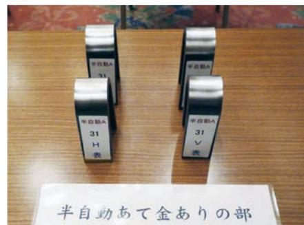
溶接接合部の曲げ試験の概観
