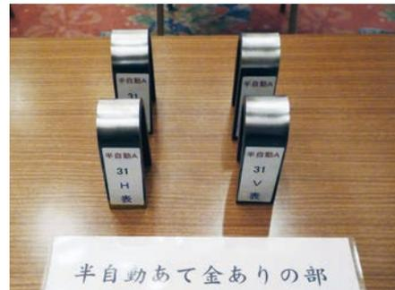
溶接接合部の曲げ試験の概観
