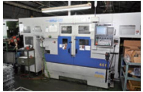
▲今回導入した平行2軸CNC旋盤
